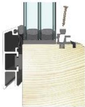
3. Befestigung G-Fix 02 mit 3,5 mm Spanlattenschraube
