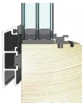
5. Spanlattenschraube voll anziehen sodass sich die Glasscheibe um ca. 1,5 mm in Richtung der Außendichtung verschiebt
