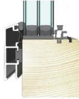
2. G-Fix 02 in Führungsnut einsetzen. Achtung: sollte G-Fix 02 nur schwer eingesetzt werden können so ist die Glasscheibe nicht korrekt positioniert
