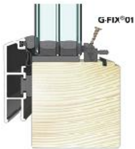
3. G-Fix 01 am Fensterelement fixieren und mit einer 3,5 mm Spanplattenschraube mit mindestens 35 mm Länge befestigen
