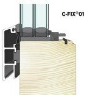
5. Glasscheibe befindet sich nun mit dem richtigen Anpressdruck an der Außendichtung
